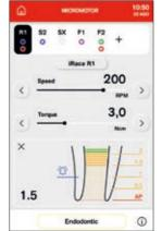
Расстояние до апекса показано на дисплее во время инструментальной обработки канала. Приближение апекса проверяется программой ENDO. Когда апекс достигнут, функция Арех-Stop прерывает вращение
